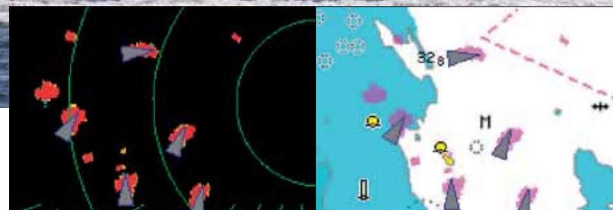
AIS mål overlay på radar (vänster) och på kartbild (höger)
